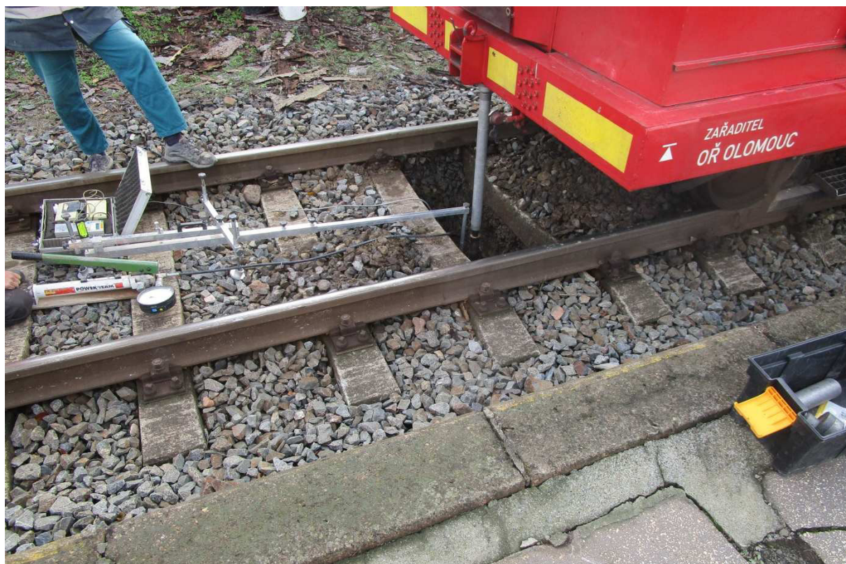
Obr. č. 2.: Pohled na realizaci statické zátěžové zkoušky.
