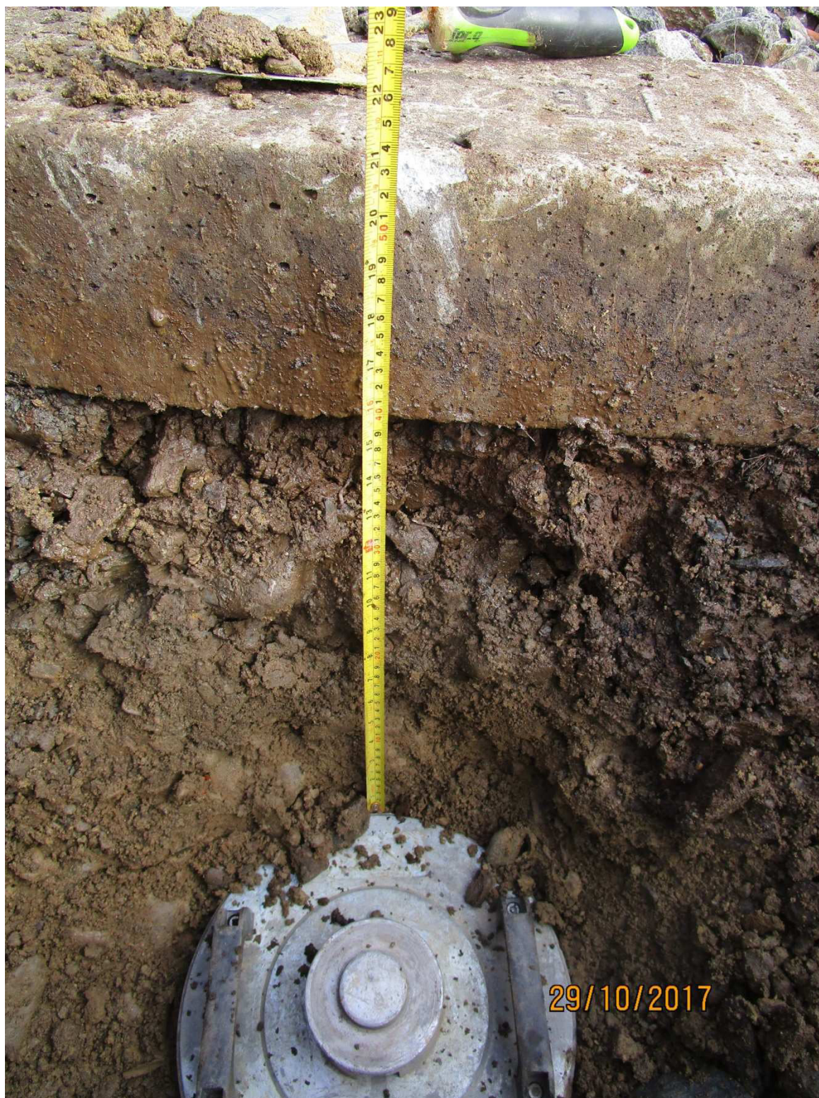
Obr.č.1.: Pohled na kopanou sondou KS-R1. Pod betonovým pražce byl zastižen výron vody.
